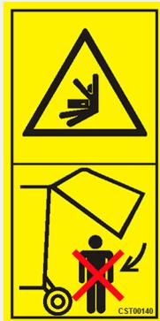
No se sitúe debajo del portón trasero subido ni intente realizar ningún ajuste en la máquina cuando el portón trasero esté subido sin colocar el cierre de seguridad. Para evitar lesiones, manténgase alejado del portón trasero mientras se sube y se baja. Asegúrese también de que terceras personas estén fuera de la "Zona de Peligro" antes de operar el portón trasero.
