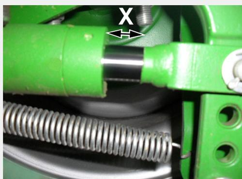
1. Compruebe la distancia "X" antes de accionar los frenos y nuevamente cuando se hayan accionado. El valor para "X" debe estar entre 12 y 18 mm.
