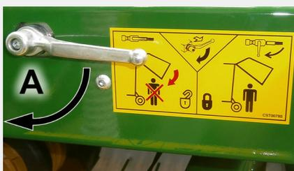
1. Antes de llevar a cabo el procedimiento siguiente, asegúrese de que la cámara de pacas esté vacía y de que no ningún residuo o restos de cultivo sueltos obstaculicen los rodillos y la(s) correa(s). Para ello, abra la puerta de la cámara y, a continuación, apague el tractor y retire la llave de contacto.
