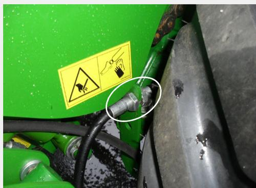
5. Utilice el ajustador junto a la rueda para tensar el cable. Este paso debe realizarse en ambas ruedas. Asegúrese de que las contratuercas estén bien apretadas contra las arandelas dentadas.
