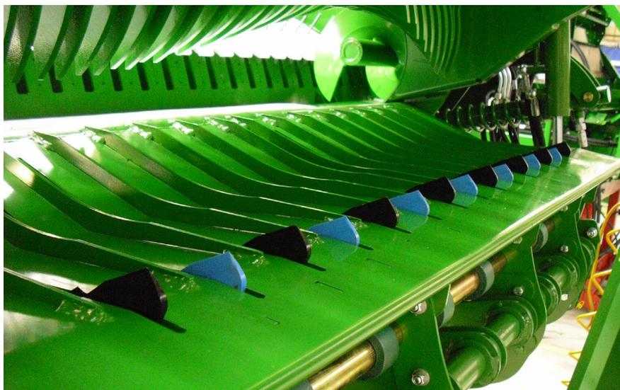
**Modo de desbloqueo: cuchillas retraídas y suelo del canal bajado**
