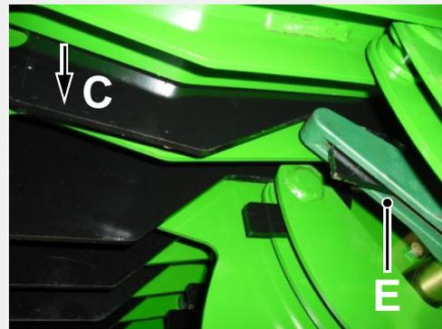
8. Para instalar una cuchilla nueva (C), introdúzcala en la parte posterior de la ranura del suelo abatible (D), de modo que encaje con el brazo accionador en posición elevada (E). A continuación, gire la cuchilla hacia abajo (F) mientras la sigue empujando hacia la parte posterior de la ranura (D), hasta que quede una separación de 5-10 mm entre la zona delantera dentada y el extremo delantero de la ranura (G), como se muestra.
