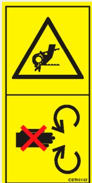
Nunca hacer ajustes o tocar en la unidad de red, mientras la TDF no esté desenganchada y el tractor esté apagado y la llave de contacto sacado. También se recomienda que se libere la tensión de la cuchilla del sistema de red para evitar su activación accidental.
