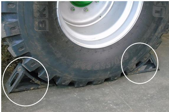
En la mayoría de los casos, ambos calzos de las ruedas se podrían utilizar en una rueda, delante y detrás, tal y como se muestra. La única excepción es cuando la máquina se aparca es un terreno escarpado. En ese caso, se debe utilizar un calzo en cada rueda, en el lado más bajo del desnivel.
