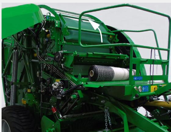
2. Levante la barra del freno del rodillo de red hacia arriba hasta que encaje en la posición elevada.
