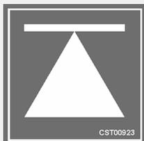
Puntos de apoyo para gato hidráulico (CST00923)
