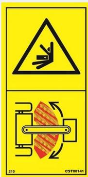
No permanezca en la zona de articulación cuando el motor del tractor esté en funcionamiento
