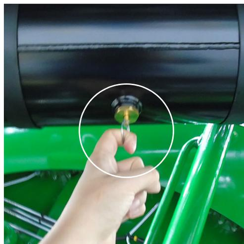
Un tractor puede mover la máquina, sin un sistema de frenos neumáticos, incluso si el depósito de aire está lleno y los latiguillos no están conectados. Localice el tanque del depósito de aire en el lateral de la máquina o bajo la plataforma. Tire del anillo que está debajo que libera el aire y sujételo hasta que haya escapado todo el aire.
