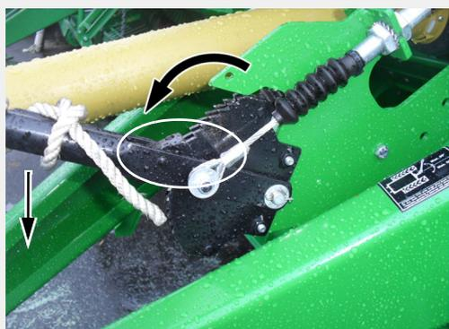
6. Para activar los frenos, bastaría con tirar de la palanca hasta la mitad del recorrido. Si puede tirar de la palanca hasta el final del recorrido, ajuste los cables a la altura de las ruedas hasta que solo pueda tirar hasta la mitad del recorrido.
