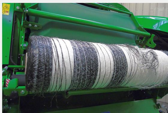
3. Retire el material de embalaje y el núcleo de cartón vacío del rollo de red terminado y deséchelo de forma responsable.
