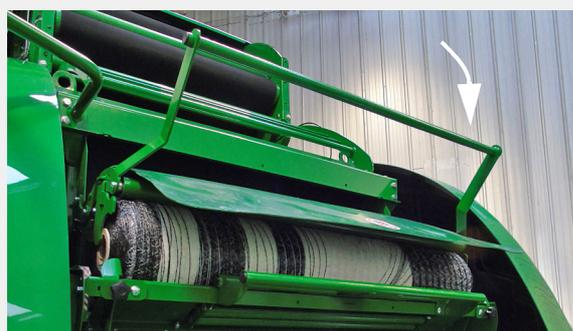
7. Presione la barra del rollo de red hacia abajo sobre el rollo.
