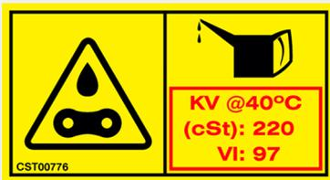
Utilice siempre aceite de cadenas de la especificación correcta para la lubricación de cadenas automáticas (CST00776)
