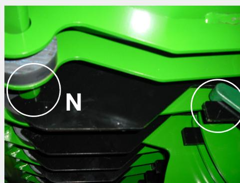
11. Tras su instalación, empuje la parte superior de cada una de las cuchillas hacia delante en la dirección de la flecha (M) como se muestra, para garantizar un encaje adecuado tanto con el eje de bloqueo como con el brazo accionador. Si la cuchilla se mueve, significa que no está colocada de forma correcta. La posición correcta se muestra en (N).
