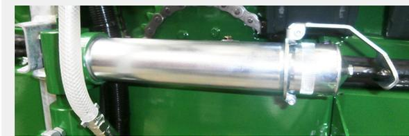
8. Deje caer el cierre del émbolo y llene el aceite de la cadena. Seguidamente, reinicie el contador de lubricante en la caja de control.
