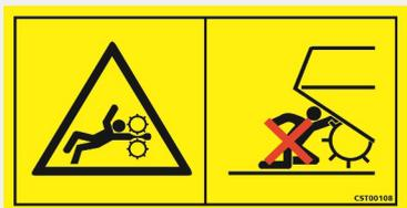
Manténgase alejado de la zona de recogida siempre que el motor esté en funcionamiento y que el eje de la TDF esté conectado al tractor
