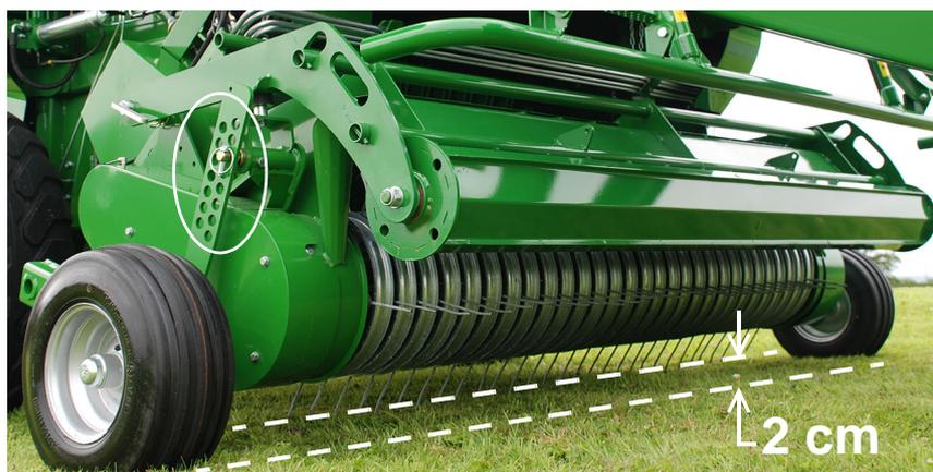
Ajuste de la altura del molinete de recogida
