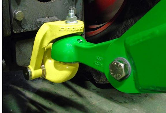
Las máquinas se preparan para el enganche a la barra de tracción del tractor. Una vez que el tractor esté acoplado a la barra de tracción, acople el eje de la TDF. En función del país de uso, también puede ser necesaria una cadena de seguridad. El desacoplamiento debe realizarse en el orden inverso al acoplamiento.
