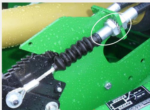
4. Una vez que las palancas de freno hayan sido instaladas, deberán ajustarse los cables del freno de mano. Coloque los ajustadores roscados de ambos cables en la palanca del freno de mano, de modo que la mayor parte de la rosca disponible esté hacia la palanca (como se muestra). Asegúrese de que las contratuercas estén bien apretadas contra las arandelas dentadas.
