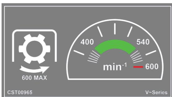
Configuración caja de cambios 540 rpm
