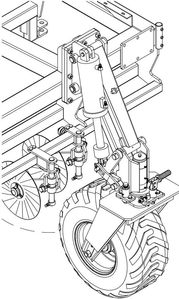
1-Levantar los soportes de labranza ubicados en el radio de giro de la rueda.
