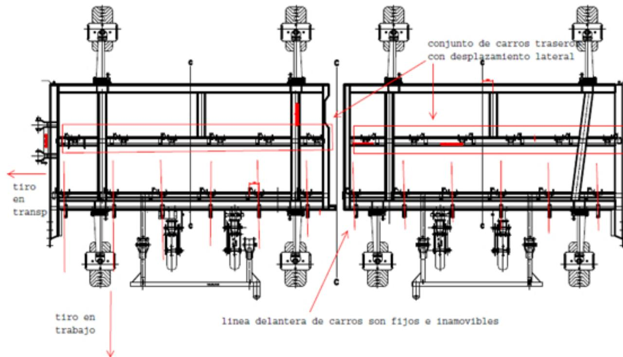
El trabajo de desplazamiento de carros traseros se debe hacer de a un módulo a la vez. Para ello se debe proceder a la instalación y conexión del cilindro hidráulico en el lugar adecuado para generar el movimiento transversal.
