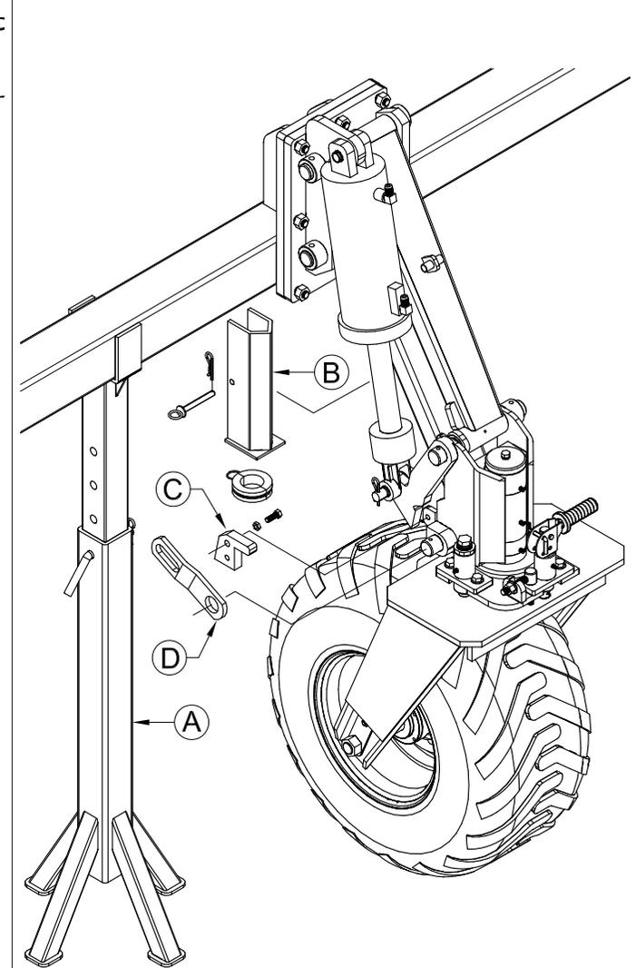
3-Colocar pie de apoyo (A) en el chasis. Abulonar tope de transporte (C). Montar traba con corredera (D). Colocar tope de cilindro (B).
