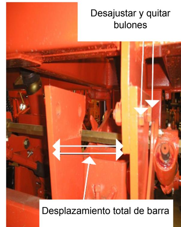
Configurar los cuerpos de siembra a las distancias deseadas. Para que los bulones y tornillos coincidan con los anclajes, se recomienda bajar la maquina al suelo para que los cuerpos de siembra y la barra se acomoden en su lugar. Proceder al anclaje y ajuste correpondientel, colocar tornillos de sujeción. Revisar y ajustar todo nuevamente y proceder a levantar la sembradora.
