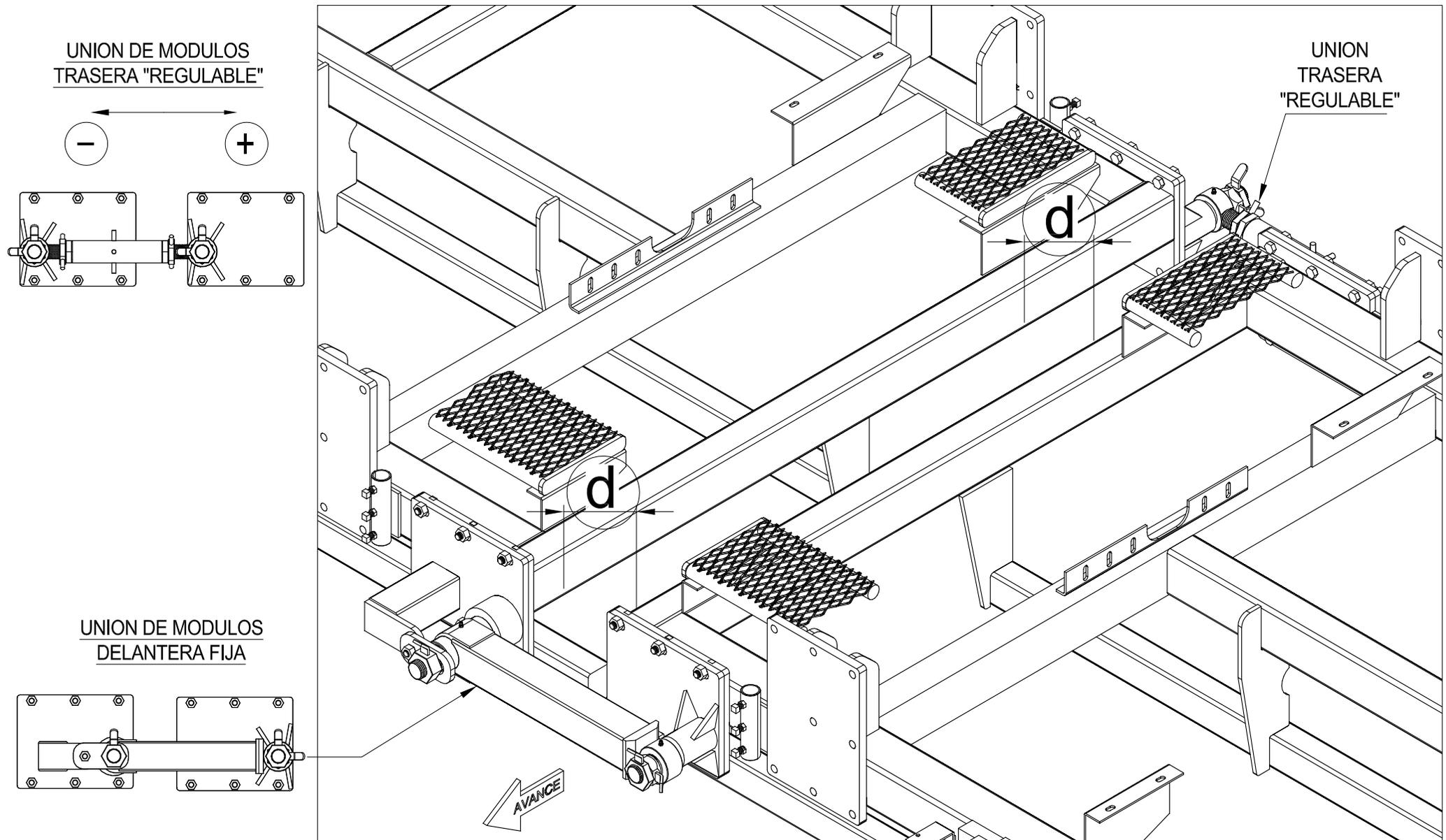
**-IMPORTANTE:** VERIFICAR LA CORRECTA ALINEACION DE LOS MODULOS DE MAQUINA PARA TRANSPORTE COMO PARA POSICION DE TRABAJO. PARA CORREGIRLA, UTILIZAR LA REGULACION DE LA PLACA TRASERA MOVIL, ACERCANDO O ALEJANDO EL 2º MODULO HASTA CONSEGUIR LA MISMA DISTANCIA "d".
