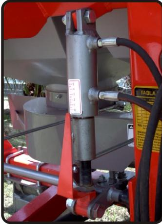
En esta posición (posición de fabrica) el tope del cilindro esta totalmente levantado y el cilindro no se puede abrir, por lo tanto las guillotinas permanecen cerradas.
