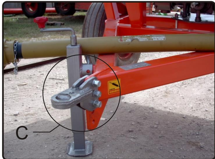
Figura N° 1 - Ajuste enganche lanza
